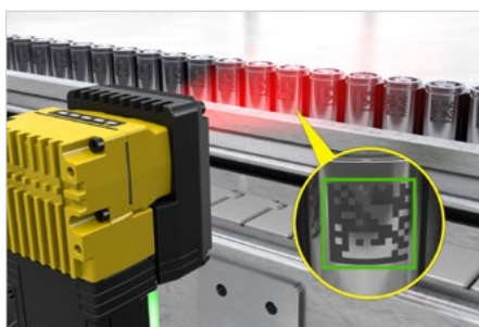
電動車 DPM 讀數：掃描圓柱型電池彎曲表面上的 DPM 代碼
